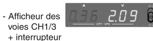
Permet d'afficher les tension et courant des voies 1 et 3. L'interrupteur situé sur la droite permet de sélectionner la voie1 ou la voie 3.
