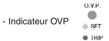
Indicateur de limite de tension : il est vert pendant le paramétrage de la limite et rouge lorsque la tension de sortie dépasse la valeur paramétrée.
