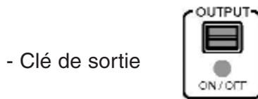
Interrupteur de contrôle de la sortie : il active (vert) ou désactive (rouge) la sortie pour les trois voies.
