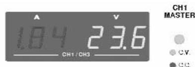
Note : l'afficheur de la voie 1 indique le courant de sortie (le potentiomètre de réglage du courant de la voie 2 doit être au maximum). La valeur de la tension en sortie est égale au double de la valeur affichée sur l'écran de la voie 1 (dans le cas présent, la sortie est de  $23,6 \times 2 = 47,2$  V).
