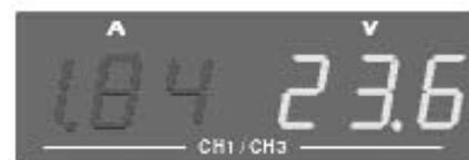
Note : le niveau de courant de sortie est égal à  $1,84 \times 2 = 3,68$  A dans le cas présent (on double la valeur affichée sur l'écran de la voie 1). La niveau de tension de sortie est dans le cas présent de 23,6 V comme indiqué.
